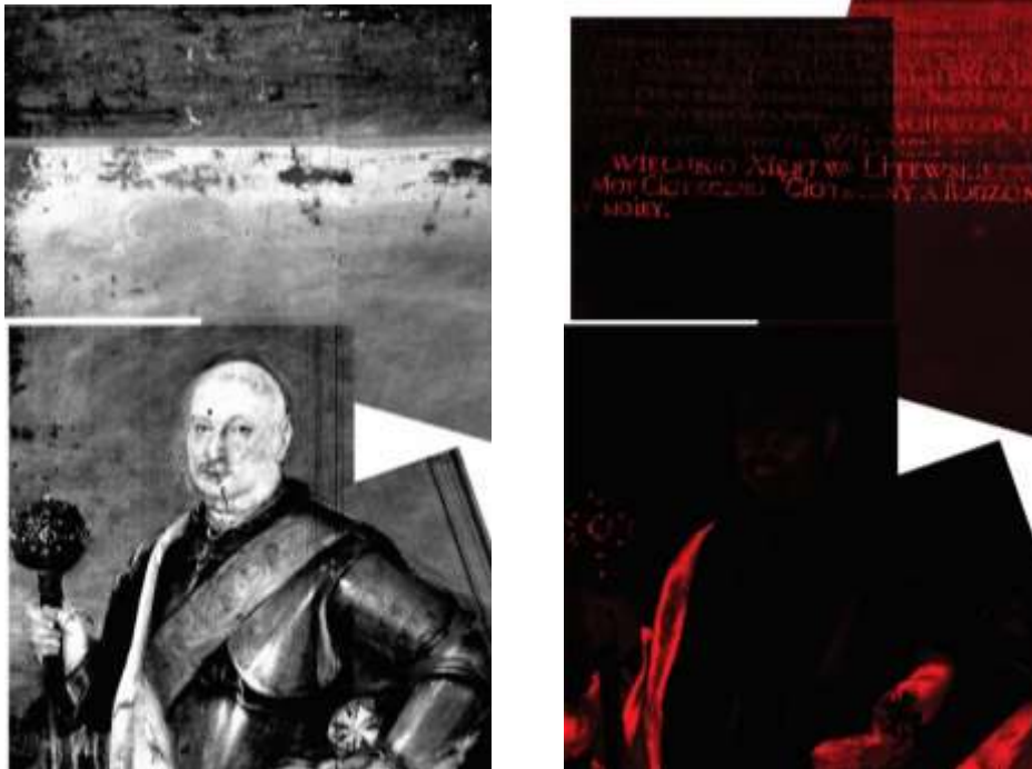
il. 43,44 Portret Michała Radziwiłła Rybeński . Makrofluorescencja rentgenowska. Mapy rozkładu Pb zawartego w bieli ołowiowej i Hg zawartej w cynobrze. Fot. M. Goryl
