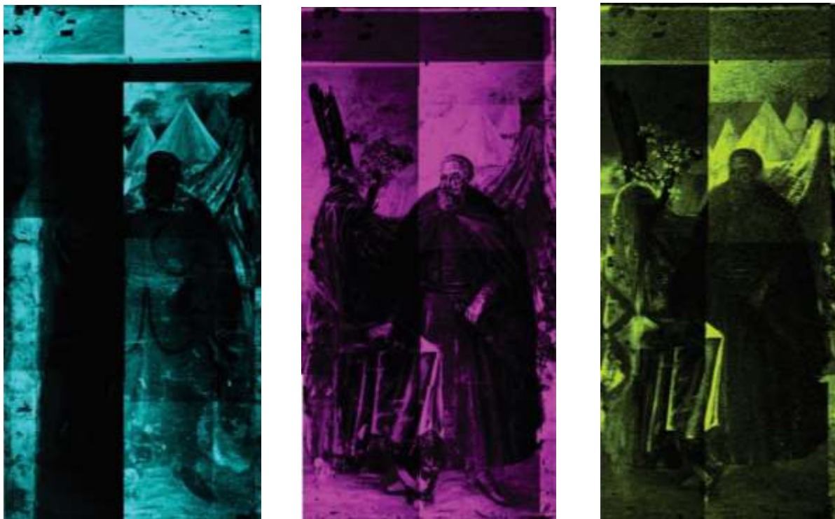
il.13,14,15 Portret Marcina Kazanowskiego z Czepielowa . Badanie makrofluorescencji rentgenowskiej. Mapy rozkładu cynku (obecnego w bieli cynkowej), baru (obecnego w bieli barytowej) i chromu (obecnego w żółcieniach i zieleniach chromowych) – pigmentów XIX wiecznych, widocznych w warstwie wierzchniej (przemalowaniu). Fot. M. Goryl
