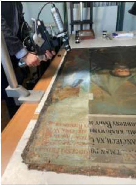
il.21-22 Portret Marcina Kazanowskiego . Widok podczas wykonywania pomiarów mikroskopowych nawarstwień. Fot. K. Siwczyńska (VIS), K. Witek (Keyence).
