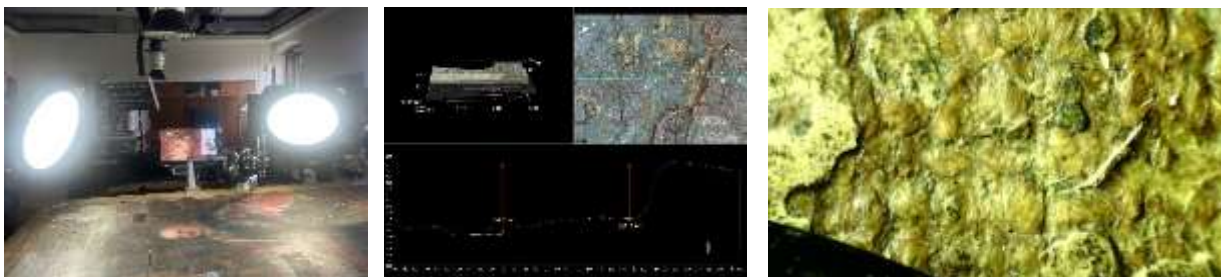
il. 51,52,53 Portret Michała Radziwiłła Rybeński . Widok podczas wykonywania makropowiększeń Keyence, pomiary grubości warstw i zbliżenie splotu płótna. Fot. K. Siwczyńska (VIS), K. Witek (Keyence)
